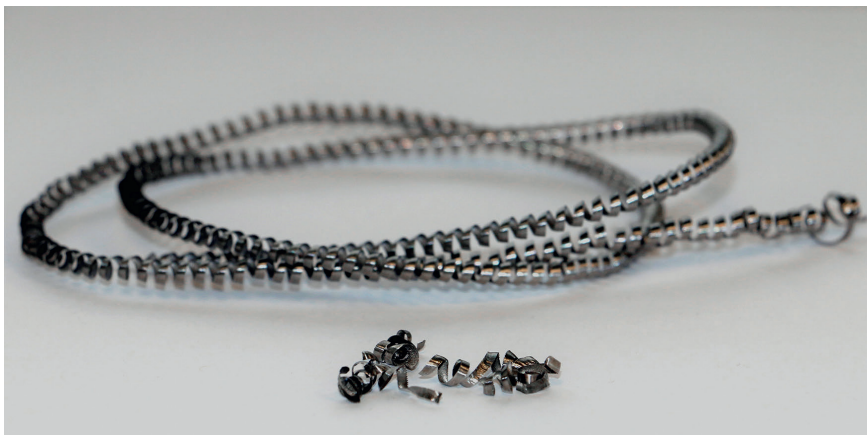
1 Mit Schwingungsunterstützung erzeugte kurze Späne (Bildvordergrund) im Vergleich zu langen Spänen (konventioneller Drehprozess mit identischen Parametern) © Fraunhofer IWU
